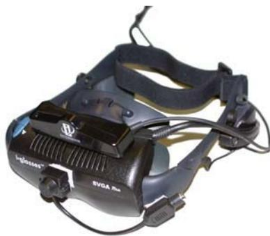
Fig. 1: HMD com sensor de orientação e micro câmara
