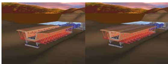
Figura 9. Betonagem do primeiro segmento.
