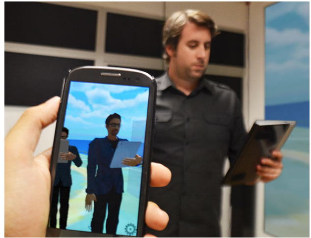
Figura 4. A Janela Virtual oferece uma visão pessoal para o mundo virtual, mostrando avatares com a posição e orientação de acordo com a Wall, do ponto de vista do proprietário do dispositivo. Neste caso, dois participantes, um local e um remoto.
